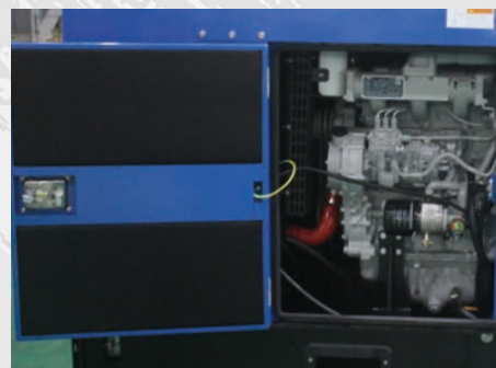
Vano manutenzione interna
